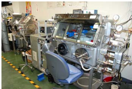
図11 ここからは先端研内部にある実験装置の一部を紹介します。写真はグローブボックスです。リチウムイオン二次電池の開発には必須です。
