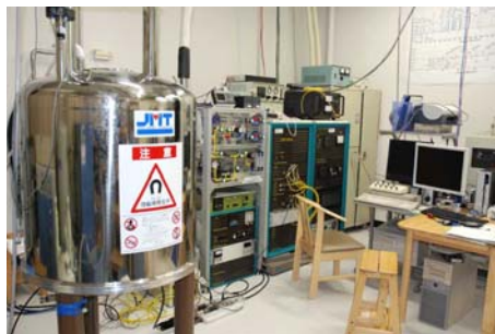
図14 300MHz超伝導マグネットとCMX Infinity 300。奥には液体窒素製造機と自動供給機が見えます。
