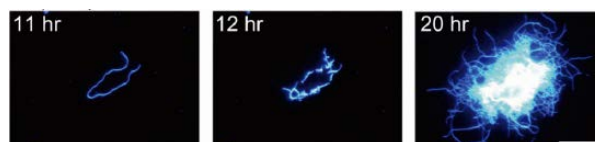
図1. レーザー照射による A \beta (1-40) 線維の増殖。一線維上で線維の断片化等が生じ、その後に爆発的に線維が増殖した。スケールバーは 10 \mu m。
