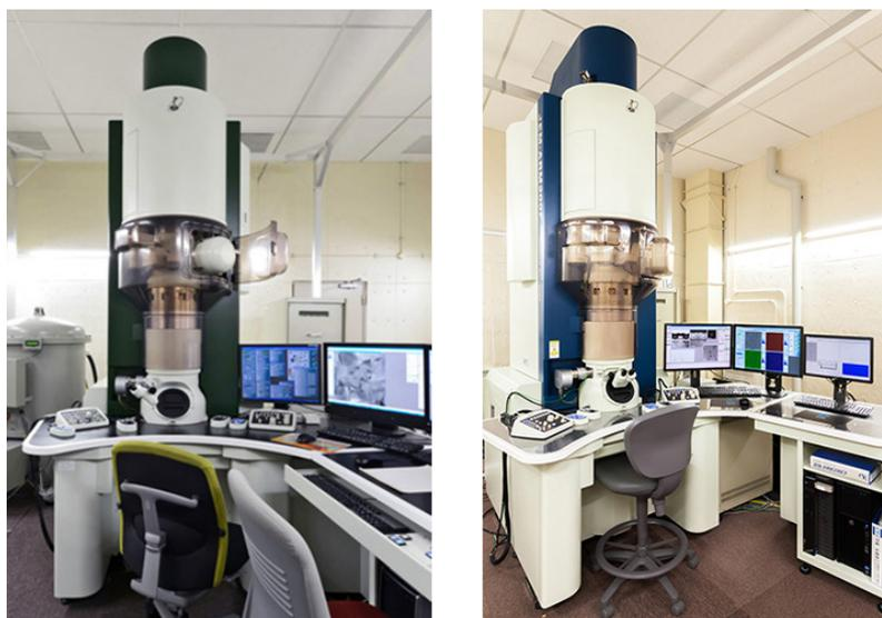
図6 本研究で活用した収差補正高分解能走査・透過電子顕微鏡。JEM-ARM200F (左)とACCELARM (右)。JEM-ARM200Fは、有感面積が100mm<sup>2</sup>の大口径シリンドリフトX線検出器を世界で初めて搭載した。ACCELARMは高次の球面収差まで補正する新しい補正器を搭載した1号機であり、30, 60, 80, 120, 200kVで収差補正がなされており、観察対象に合わせて加速電圧を設定して高分解能観察・解析が可能である。また上記の大口径SDDを2機搭載している。一連の研究成果を眺めて見ると、この5年間で原子構造・状態解析の精度が格段に向上していることに気づかされる。
