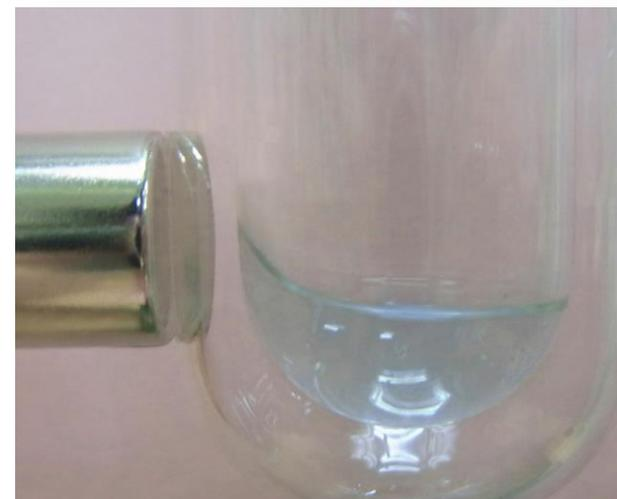
液体酸素は、沸点が90Kの淡青色の液体である。磁石に近づけると、液体酸素は磁石に吸い寄せられる。
